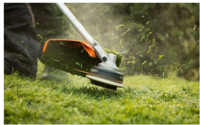
Штанга, редуктор и режущие инструменты у STIHL FSA 130 такие же, как у бензиновой модели STIHL FS 131
