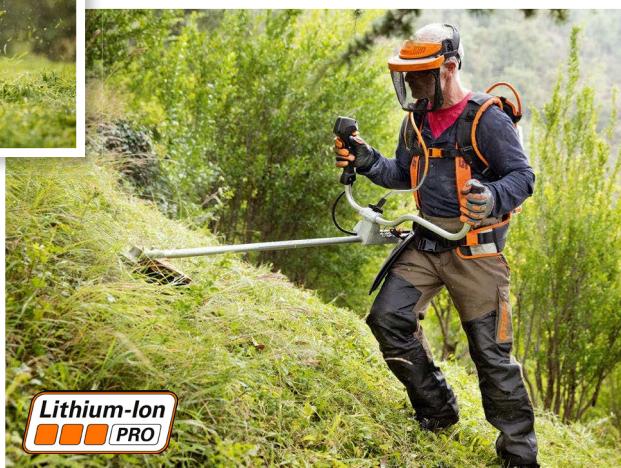
Штанга, редуктор и режущие инструменты у STIHL FSA 130 такие же, как у бензиновой модели STIHL FS 131
